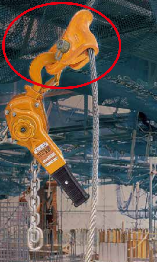
◎KITO钢丝绳专用夹具，不可作吊起重物时的吊具之用
